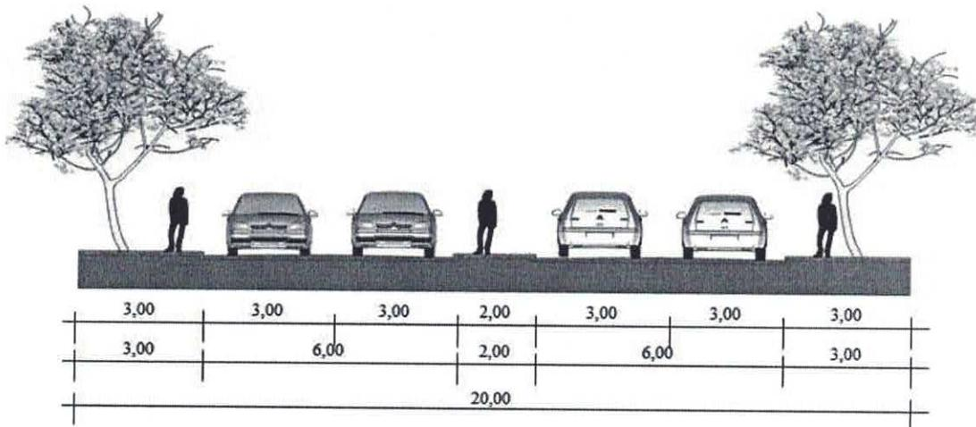
Figura 4 - Via com gabarito de 20 m com canteiro central
