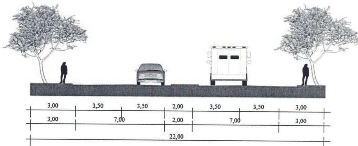
Figura 6 - Via com gabarito de 22 m com canteiro central
