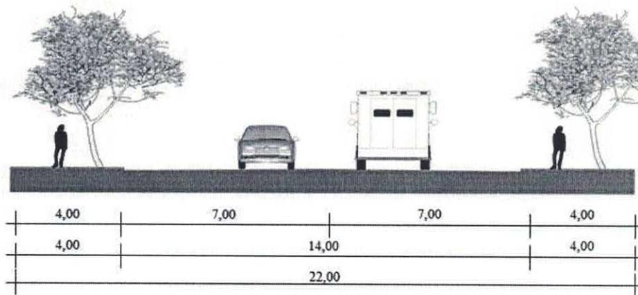
Figura 5 - Via com gabarito de 22 m sem canteiro central
