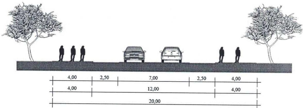
Figura 3 - Via com gabarito de 20 m sem canteiro central
